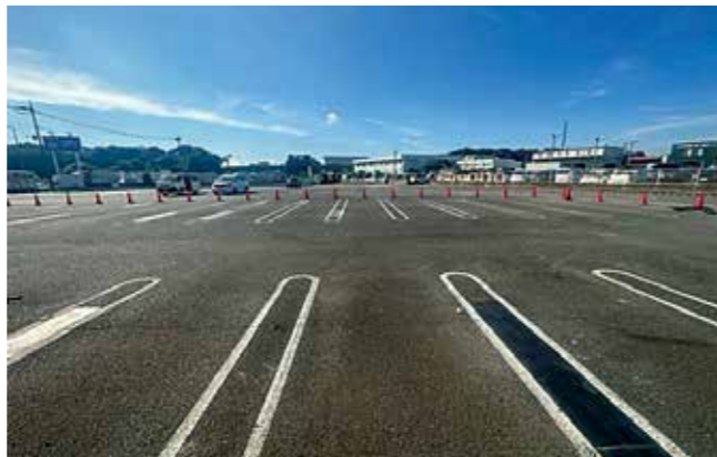
ソーラーカーポートはU字型の白線ならば線を引直すことなく設置可能
